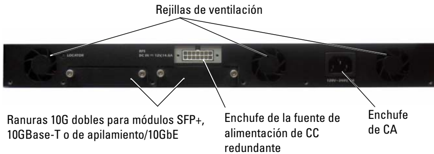
Ilustración 1-9. Panel posterior de PC7024P y PC7048P
